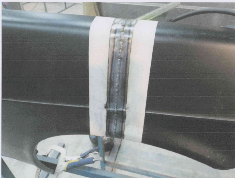
Сварка переднего крыла
